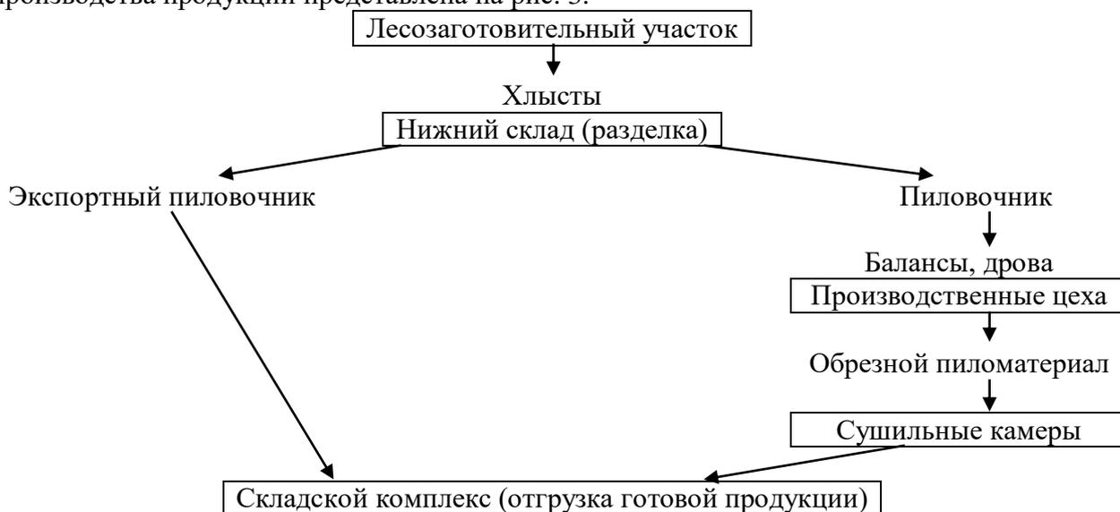
Рис. 3. Технологическая схема производства продукции
